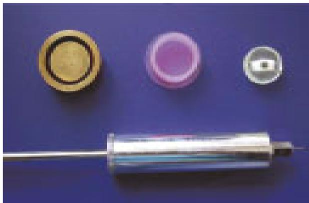
FIGURA 1: Fôrma de latão/matriz de silicone/corpo-de-prova.
