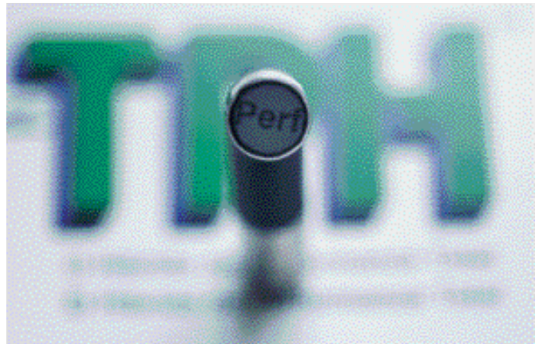
FIGURA 6: Fibra ótica rígida em perfeitas condições, pois reflete nitidamente o texto posicionado na sua base.
