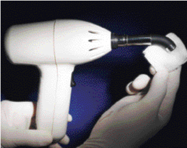
FIGURA 2: Limpeza da ponta de fibra ótica rígida com gaze embebida em álcool 70%.
