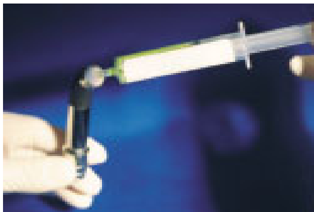
FIGURA 3: Procedimento de manutenção da fibra ótica aplicando-se pasta diamantada específica para a utilização em aparelhos fotopolimerizadores.
