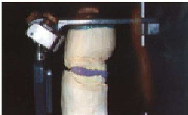
**FIGURA 4:** Posição do ASA para leitura do valor do ângulo correspondente à inclinação da eminência articular.
