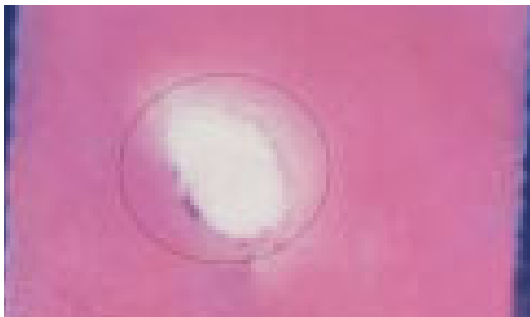
FIGURA 2: Coroa do dente bovino incluída em resina acrílica, com face vestibular lixada.
