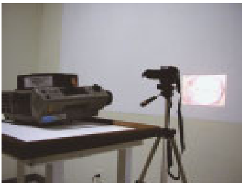
FIGURA 7: Digitalização de slides através do uso da câmera digital. Os slides são projetados em uma tela; posteriormente, a imagem da tela é fotografada (digitalizada) pela câmera digital corretamente posicionada em um tripé.
