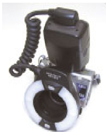
FIGURA 5: Câmera digital Canon G3 associada a um tubo de extensão e acoplada ao flash circular Canon MR-14.
