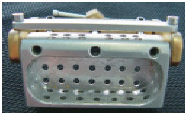
FIGURA 2: *Parte interna da moldeira com os três orifícios por onde passam os pinos-guias do modelo padrão. / Parte interna de la cubeta, con los tres orificios por donde pasan los espigones-guías del modelo patrón.*
