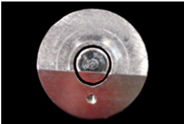
FIGURA 3: Cápsula metálica adaptada ao troquel.
