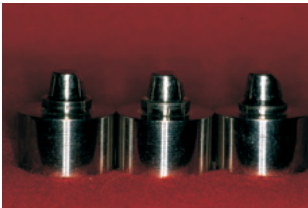
FIGURA 1: Modelos padrão de aço inoxidável: chanfro, ombro arredondado e bisel 135o.
