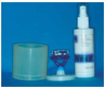
**FIGURA 5:** Conjunto: anel de inclusão de silicone, base formadora de cadrinho com a infra-estrutura encerada, unida aos condutos de alimentação, e líquido surfactante. I *Conjunto: Cilindro de silicone para revestido, base formadora del crisol con la infraestructura encerada unida a los conductos de alimentación y líquido humectante.*
