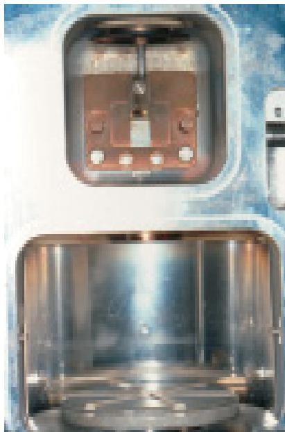
**FIGURA 17:** Câmera superior e inferior da máquina de fundição. I Câmera superior e inferior de la máquina de colado.
