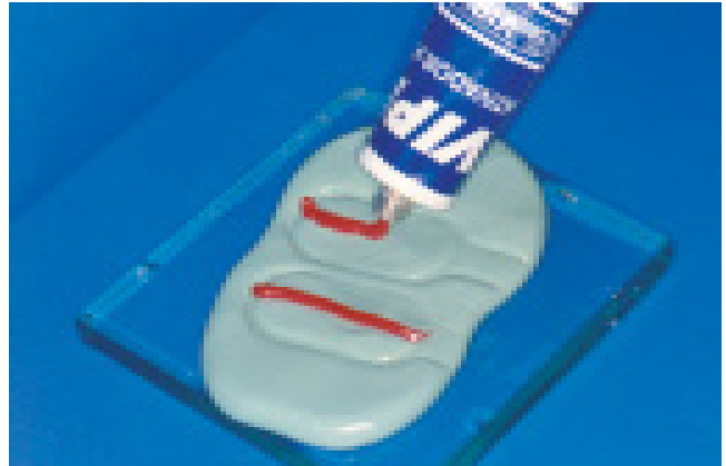
FIGURA 3: Ativando o silicone com catalisador. | Activación de la sílicona con catalizador.
